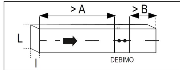
Montaje de aspa DEBIMO en conducto rectangular.
