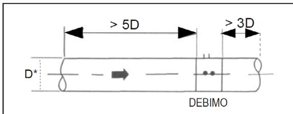
Montaje de aspa DEBIMO en conducto circular.
