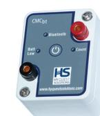
una interconexión entre la salida del interruptor de láminas del TBRG y el software de calibración de la aplicación FCD, utilizado
