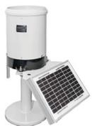
**Sistema autónomo RainTrak Undercover:** El TB4 se puede usar como parte del RainTrak, un sistema confiable y autónomo para el monitoreo y reporte de la lluvia en
